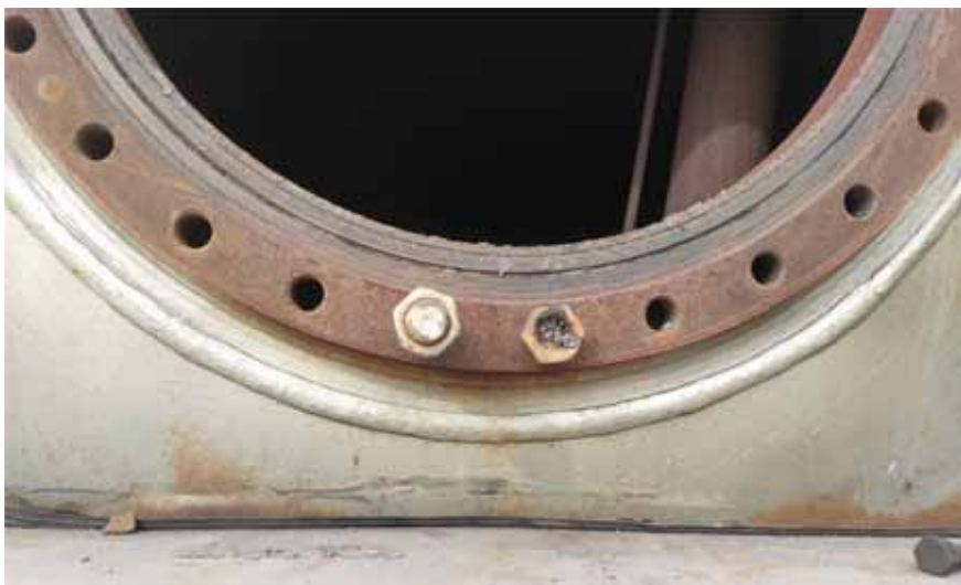
Рис. 11. Приваренная гайка к обломанной шпильке на люке цистерны для транспортировки сжиженных углеводородных газов типа ЦТ (ППЦТ-36 зав. № 209)
