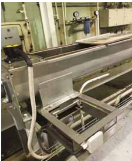
Рис. 17. Шнековый конвейер с открытой крышкой короба зерноочистительного отделения мельницы
