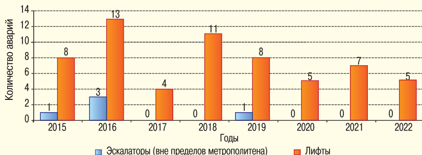
Рис. 38. Количество аварий на опасных объектах (лифтах, подъемных платформах для инвалидов, пассажирских конвейерах (движущихся пешеходных дорожках), эскалаторах вне метрополитенов)
