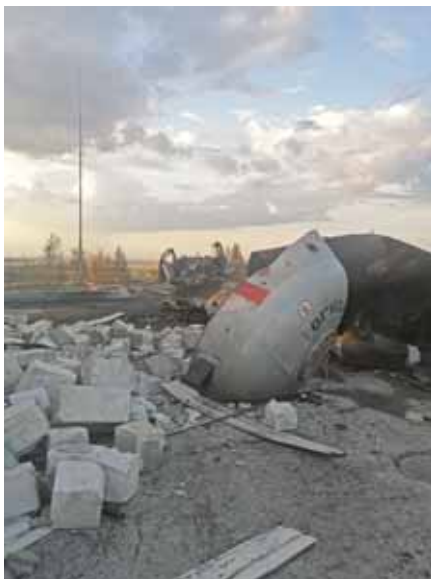
Рис. 16. Оторванное в результате взрыва днище цистерны газовоза
