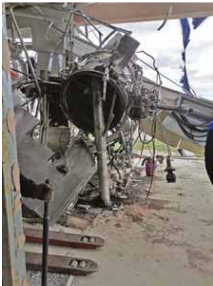
Рис. 10. Разрушенный байонетный затвор и днище процесс-филтра Ф-2
