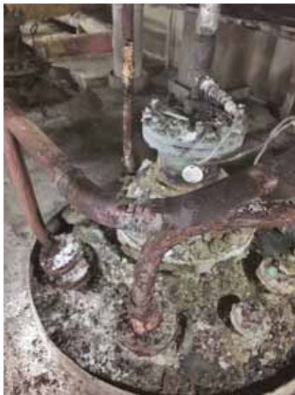
Рис. 3. Место разгерметизации трубопровода
