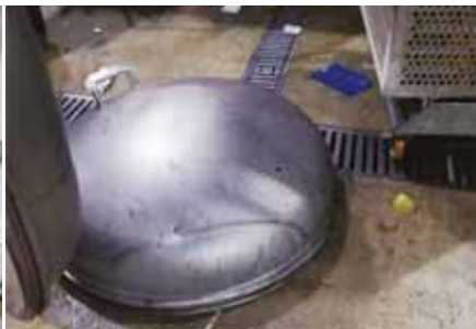
Рис. 15. Сорванная крышка автоклава LEVATI PRIMA
