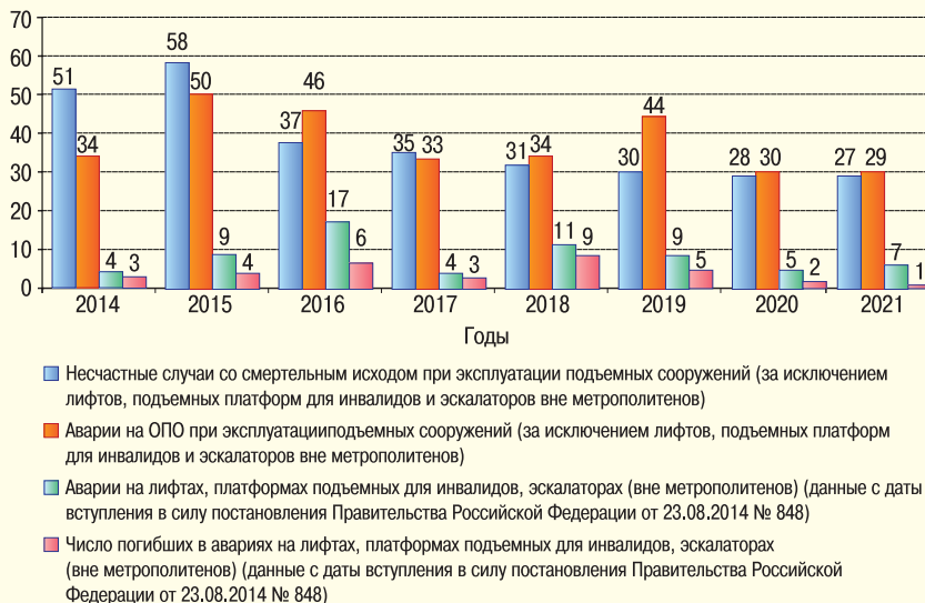
Рис. 20. Динамика аварийности и смертельного травматизма при эксплуатации подъемных сооружений
