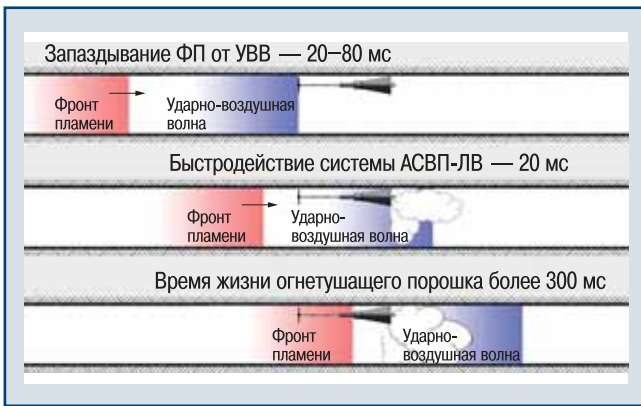
▲ Рис. 3. Схема срабатывания системы АСВП-ЛВ
