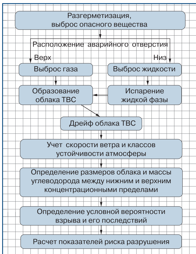
▲ Рис. 1. Схема проведения анализа риска разрушения зданий при взрывах ТВС
